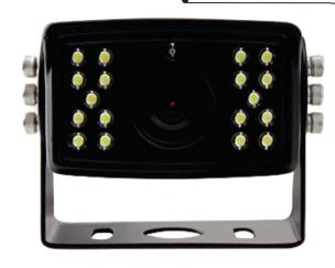
A câmera HD night vision K2on é o que existe de mais moderno em tecnologia de câmeras no sistema. Com seu sistema anti-ofuscamento e visão noturna colorida ela é ideal para operações noturnas, garantindo imagens de alta qualidade em ambientes com pouca ou nenhuma luz. Seu corpo em alumínio proporciona uma melhor resistência á impactos e conta com proteção IP 69.
