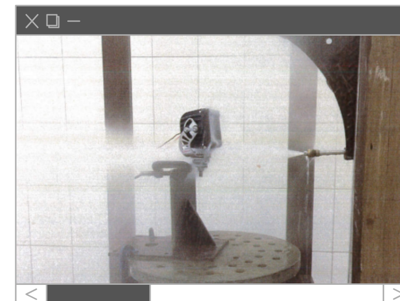
Farol durante teste de jato d'água de alta pressão
